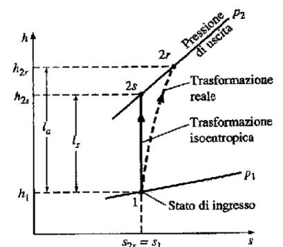
FIGURA 8.50 Diagramma  $h$ - $s$  per la trasformazione reale e isoentropica di un compressore adiabatico.
