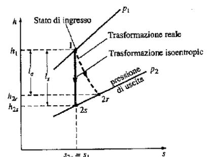
FIGURA 8.48 Il diagramma  $h$ - $s$  per le trasformazioni reale e isoentropica di una turbina adiabatica.
