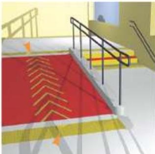
✓ È molto utile indicare l'inizio e la fine di una rampa, sia se questa è costituita da gradini piuttosto che da un piano inclinato, utilizzando la segnaletica a pavimento (segnali tattile plan-tari) costituita da una doppia fila di piastrelle a bolli in rilievo che indica lo stop.
