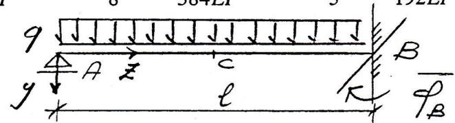
3 Determinare con il Metodo delle Forze quale delle seguenti espressioni fornisce il Momento M<sub>B</sub> in B.
