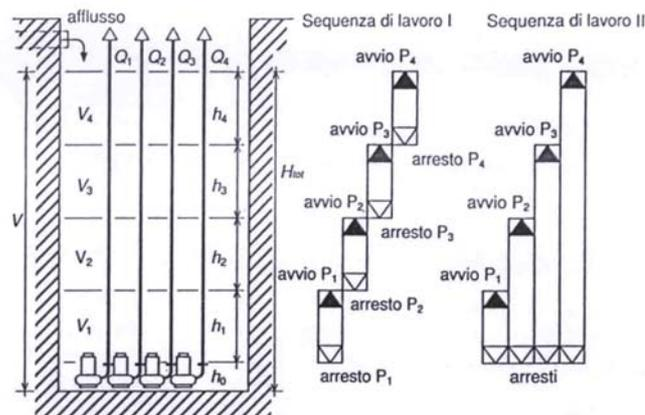
Per la sequenza I si dimostri inoltre l'equazione utilizzata per il calcolo del volume da attribuire a ciascuna pompa.
