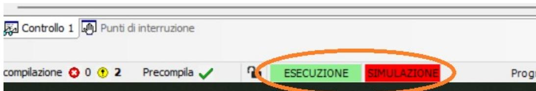
Qui si può operare come Codesys 2.3, ovvero cliccando due volte sul contatto finché diventa blu e poi premendo CTRL + F7, in modo da forzare il cambio di stato del contatto, come se stessi fisicamente agendo sull'oggetto hardware collegato al morsetto %IX0.0. Vedremmo così che la bobina diventa true.
