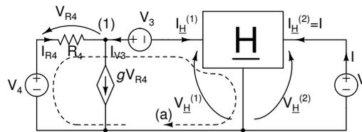
Si indichino con  $V_{\underline{H}}^{(1)}$  e  $I_{\underline{H}}^{(1)}$  la tensione e la corrente alla porta 1 di  $\underline{H}$ , e con  $V_{\underline{H}}^{(2)}$  e  $I_{\underline{H}}^{(2)}$  tensione e corrente alla porta 2. È immediato notare che  $V_{\underline{H}}^{(2)} = V$ , e che  $I_{\underline{H}}^{(2)} = I$  è la corrente cercata.
