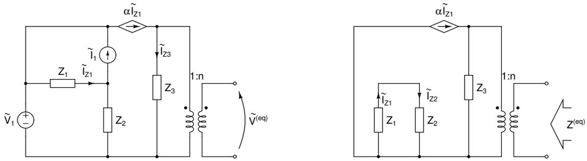
Per determinare  $\tilde{V}^{(eq)}$  è sufficiente calcolare la tensione di circuito aperto, ovvero quella per cui  $\tilde{I}_T^{(2)} = 0 \text{ A}$  e quindi anche  $\tilde{I}_T^{(1)} = 0 \text{ A}$
