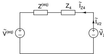
Sostituendo il circuito equivalente di Thevenin alla rete elettrica di sinistra, si arriva al circuito di figura, che è risolto da
