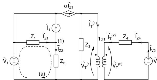
Si consideri il circuito di figura, in cui per coerenza con il cambio di notazione, il generatore di corrente comandato  $\alpha I_{R1}$  è stato sostituito, per coerenza con la notazione fasoriale, con un generatore comandato  $\alpha \tilde{I}_{Z1}$ .
