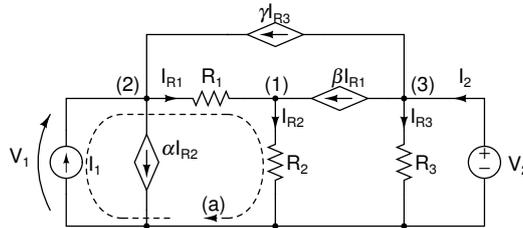
Come prima cosa si può osservare che  $V_2$  e  $R_3$  sono in parallelo, per cui  $V_{R3} = V_2$  e quindi  $I_{R3} = V_2/R_3$ . Quindi, dai nodi indicati con (1) e (2) si ha
