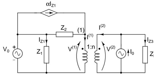
con  $Z_1 = R_1 + j\omega L_1 = 400 + 400j \Omega$ ,  $Z_2 = 1/(j\omega C_2) = -j100 \Omega$ ,  $Z_3 = j\omega L_3 = 500j \Omega$ ,  $V_0 = 4e^{j\pi/2} \text{ V} = 4j \text{ V}$ ,  $I_0 = 4 \cdot 10^{-3} \text{ A}$ .
