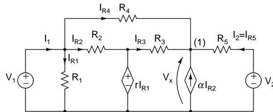
Chiamando  $V_x$  la tensione ai capi del generatore di corrente controllato  $\alpha I_{R2}$ , è possibile esprimere tutte le correnti delle resistenze:
