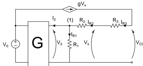
Si può notare che il generatore comandato di corrente  $gV_x$ ,  $R_3$  e  $R_2$  sono in serie, quindi  $I_{R2} = I_{R3} = gV_x$ . Inoltre, esprimendo la tensione  $V_2$  come  $V_2 = R_1 I_{R1}$ , si ha anche che  $V_x = R_1 I_{R1} + R_2 gV_x$ ,  $V_{C0} = V_x + R_3 gV_x$ .
