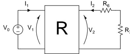
La potenza dissipata da  $R_7$  vale  $P_{R7} = R_7 I_2^2$ . Scrivendo le equazioni del due porte
