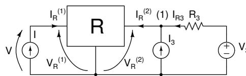
Si indichino con  $V_R^{(1)}$  e  $I_R^{(1)}$  la tensione e la corrente alla porta 1 di  $\underline{R}$ , e con  $V_R^{(2)}$  e  $I_R^{(2)}$  tensione e corrente alla porta 2, con  $V_R^{(1)} = V$  e  $I_R^{(1)} = I$ . Dalla prima delle equazioni costitutive di  $\underline{R}$  si ha
