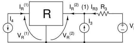
Imporre  $P_{R3} = 0$  significa imporre  $I_{R3} = 0$  o, equivalentemente,  $V_{R3} = 0$ . Procedendo come nel caso precedente, è possibile determinare  $I_{R3}$  come
