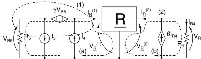
Il metodo più semplice per risolvere il circuito è quello di considerare, per il doppio bipolo  $\underline{R}$  ed il circuito collegato alla porta 2, il circuito equivalente di Thevenin calcolato al punto precedente. In questo modo il calcolo della tensione  $V_{\underline{R}}^{(1)}$  e della corrente  $I_{\underline{R}}^{(1)}$  alla porta 1 di  $\underline{R}$  risulta estremamente semplificato.
