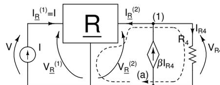
Indicando con  $V_{\underline{R}}^{(1)}$  e  $I_{\underline{R}}^{(1)}$  la tensione e la corrente alla porta 1 di  $\underline{R}$ , e con  $V_{\underline{R}}^{(2)}$  e  $I_{\underline{R}}^{(2)}$  tensione e corrente alla porta 2, si ha  $V_{\underline{R}}^{(1)} = V$  e  $I_{\underline{R}}^{(1)} = I$ .
