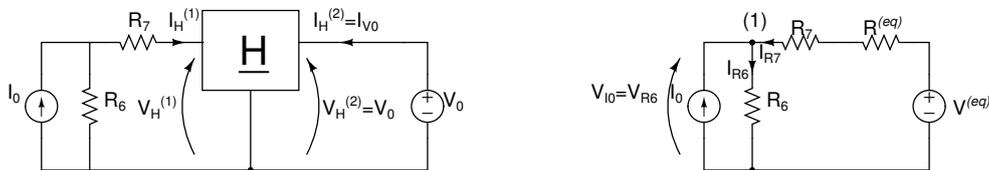
Per determinare  $P_{V_0} = V_0 I_{V_0}$  si consideri il circuito di sinistra. Ripetendo lo stesso procedimento eseguito al punto precedente, si arriva a
