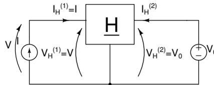
Si indichino con  $V_H^{(1)}$  e  $I_H^{(1)}$  la tensione e la corrente alla porta 1 di  $\underline{H}$ , e con  $V_H^{(2)}$  e  $I_H^{(2)}$  tensione e corrente alla porta 2, con  $I_H^{(1)} = I$ ,  $V_H^{(1)} = V$  e  $V_H^{(2)} = V_0$ . Per determinare  $V$  è sufficiente considerare le equazioni costitutive del bipolo  $\underline{H}$ . È possibile semplificare la risoluzione ricordando che  $H_{21} = 0$ .
