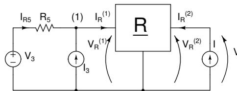
Si indichino con  $V_R^{(1)}$  e  $I_R^{(1)}$  la tensione e la corrente alla porta 1 di  $\underline{R}$ , e con  $V_R^{(2)}$  e  $I_R^{(2)}$  tensione e corrente alla porta 2, con  $V_R^{(2)} = V$  e  $I_R^{(2)} = I$ . Dalla seconda delle equazioni costitutive di  $\underline{R}$  si ha  $V = V_R^{(2)} = R_{21} I_R^{(1)} + R_{22} I_R^{(2)} = R_{21} I_R^{(1)} + R_{22} I$ . Si determini quindi  $I_R^{(1)}$ .
