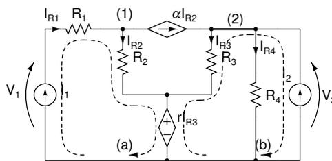
Dal circuito in figura si posso esprimere le due correnti  $I_{R1}$  e  $I_{R4}$  come  $I_{R1} = I_1$  e  $I_{R4} = V_2/R_4$ . Inoltre dal bilancio delle correnti al nodo (1) è possibile ricavare  $I_{R2}$
