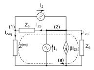
Per risolvere il circuito è ora necessari mettere a sistema il bilancio delle correnti a entrambi i nodi (1) e (2) con il bilancio delle tensioni alla maglia (a).
