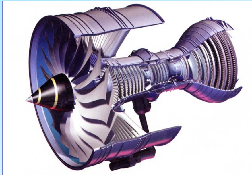
Rolls Royce Trent engine – titanium fan blades
