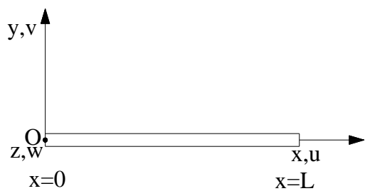
Figura 2. Sistema di riferimento per la trave soggetta a flessione.
