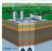
Compressione dell'aria e stoccaggio in cavità sotterranee
