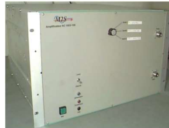
Amplificatore 3 GHz 100W
