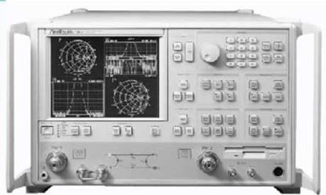
Analizzatore di rete
