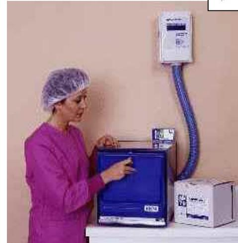
**Camera sterilizzante a Gas (ossido di etilene)**
