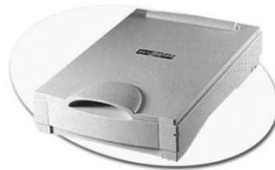
Lo scanner è un apparecchio che, similmente ad una fotocopiatrice, è in grado di riprodurre una immagine o un testo, trasmettendoli - in formato digitale - al computer al quale è collegato. Gli scanner di ultima generazione, inoltre, permettono anche l'invio immediato del documento scansionato via e-mail, o l'invio direttamente in stampa.
