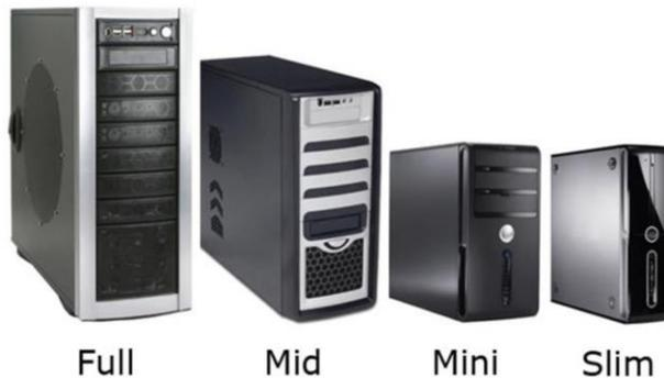
Il case è il “contenitore”, l’esoscheletro del vostro computer. I case odierni per ambiente office/home esistono di vari modelli. In ordine di grandezza decrescente: Full tower, Mid Tower, Mini Tower, Slim Tower. A seconda della tipologia ci sarà più o meno spazio per unità ottiche, hard disk, sistemi di ventilazione, ecc.
