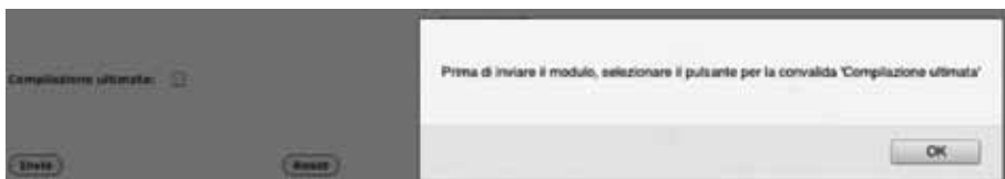
Figura 13. Funzionamento del controllo JavaScript nel caso di mancata validazione della scheda prima del suo invio definitivo
