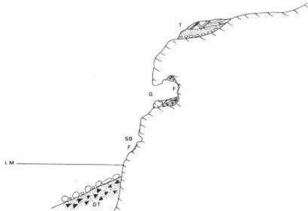
*Legenda:* T: terrazzo coperto da depositi di spiaggia ed eolici; G: ingrottamenti con fori di litodomi (F) e limitati accumuli di sedimenti litorali; SB: solco di battente; Dt: scarpata detritica sottomarina con elementi elaborati dal moto ondoso.
