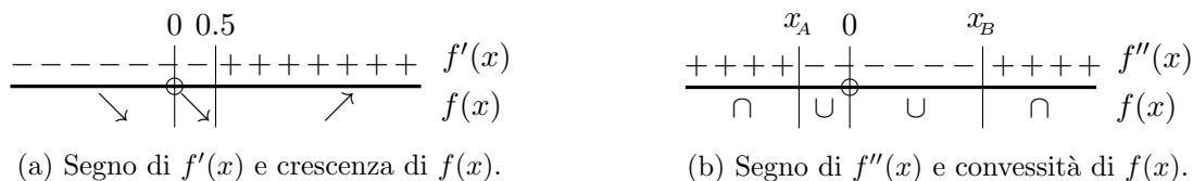
Figura 1: determinazione degli intervalli di crescita/decrecenza e convessità/concavità di f(x) .
