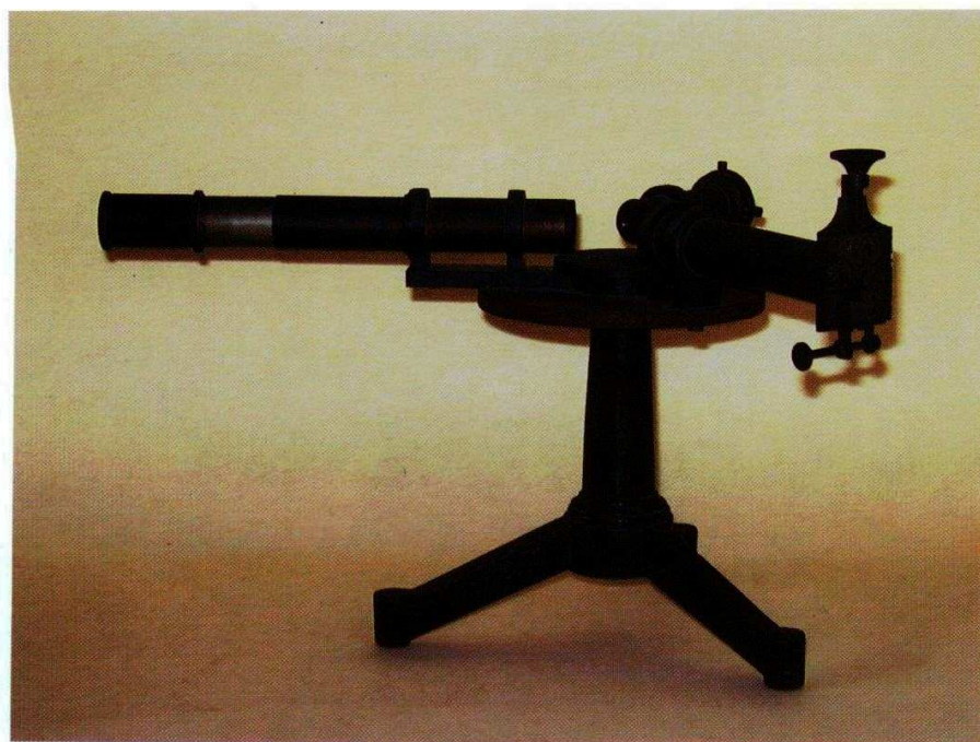
Fig. 4. Spettroscopio di Kirchhoff-Bunsen. Attribuito agli anni '40; inventato nell'800 dal chimico tedesco Bunsen e dal fisico tedesco Kirchhoff è stato in ordine di tempo il primo strumento usato negli studi di spettroscopia. Strumento ottico per l'osservazione e la misura delle righe spettrali di emissione di elementi chimici nella regione del visibile. Struttura in ferro a treppiede, con piattaforma fissa su cui sono applicati un cannocchiale, un collimatore e una sottile fenditura regolabile posta nel piano focale di una lente convergente. I raggi, resi così paralleli, vengono inviati sul prisma disperdente (che qui manca) e letti col cannocchiale.
