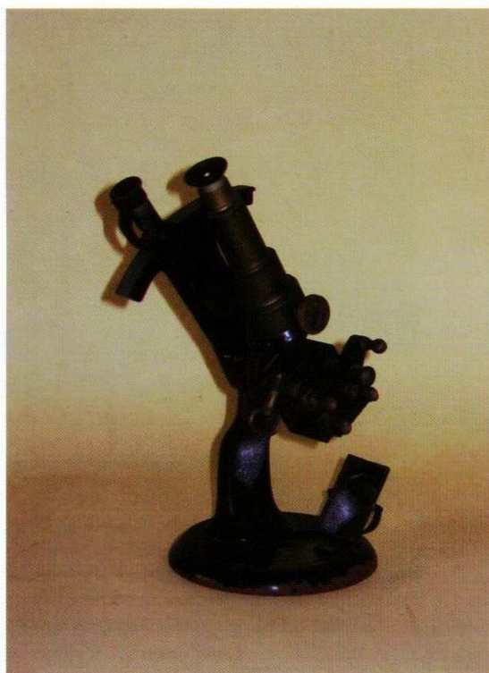
Fig. 1. Rifrattometro di Abbe della Carl Zeiss di Jena Germania. Struttura in ferro verniciato nero, sembra degli anni '40. Strumento ottico per la misura dell'indice di rifrazione di liquidi puri e di soluzioni.
